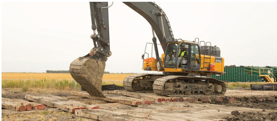
Les emprises ne sont pas conçues pour servir de routes ou de lieux d'entreposage. Le poids des véhicules, de l'équipement ou des matériaux peut endommager les pipelines situés en dessous.
